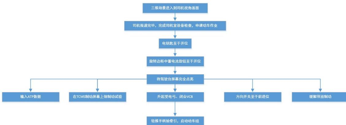
图 4 驾驶台启动流程
