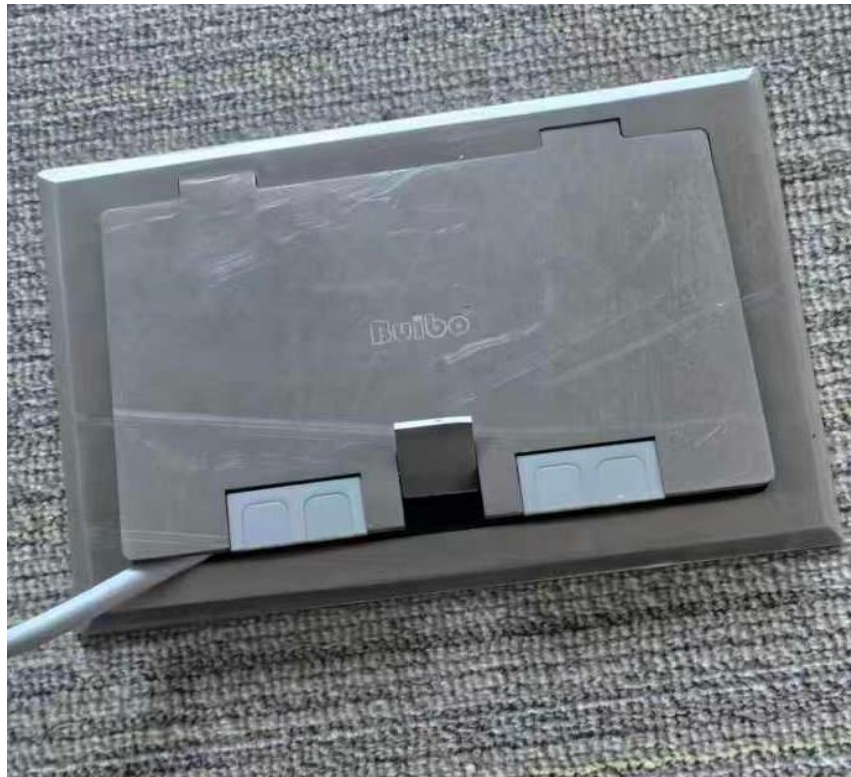
盖板压电源线 电源线应从预留出线孔穿出，保护电源线
